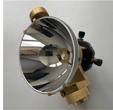
*Prototype nouvellement développé pour augmenter la sensibilité de détection des petits échantillons, comme les graines. Les échantillons sont placés dans le foyer intérieur du miroir elliptique. La photocathode du photomultiplicateur de détection se trouve au foyer extérieur.*
