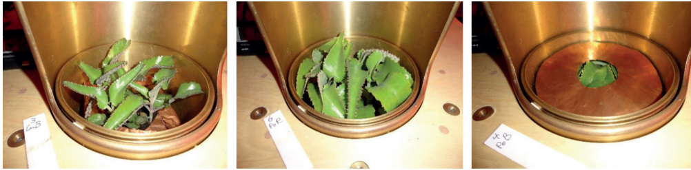
Bryophyllum-Pflanzen zur Messung in der FAS-2 Anlage. Links und Mitte: ganze Pflanzen (links unter blauem Kupfer-Metallfarblicht, Mitte unter rotem Polymerfolien-Farblicht gewachsen). Rechts: Größenstandardisierte Messung der Blätter mit Lochblech.
